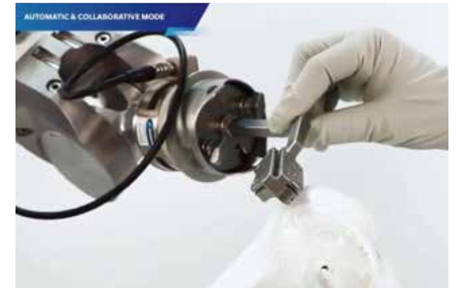
写真2:ロボット支援によるカットガイド設置
